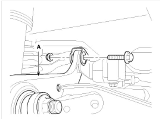
3. 拧下螺栓与螺母，拆卸后上臂(A)与副车架。
