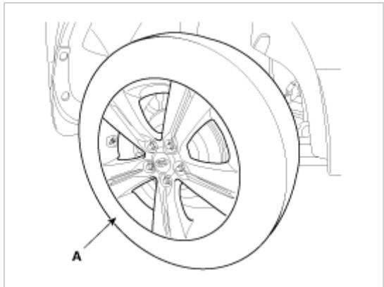
拆卸前车轮和轮胎(A)时, 注意不要损坏轮毂螺栓。
